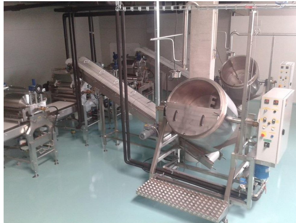
Два смесителя для выпуска двуслойных батончиков мюсли
